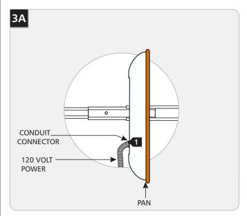
Connect the 120 volt power line conduit to the conduit connector.
