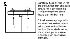
attach to green ground screw. Pele 1/2 pulgada (1.25cm) del aislamiento (cubierta) de los cables. Una los cables, torciendolos juntos con el alicate. Asegúrese de unir cable negro con negro (positivo) y blanco con blanco (neutro). Corte el sobrante de las puntas de los cables. Una el cable de
