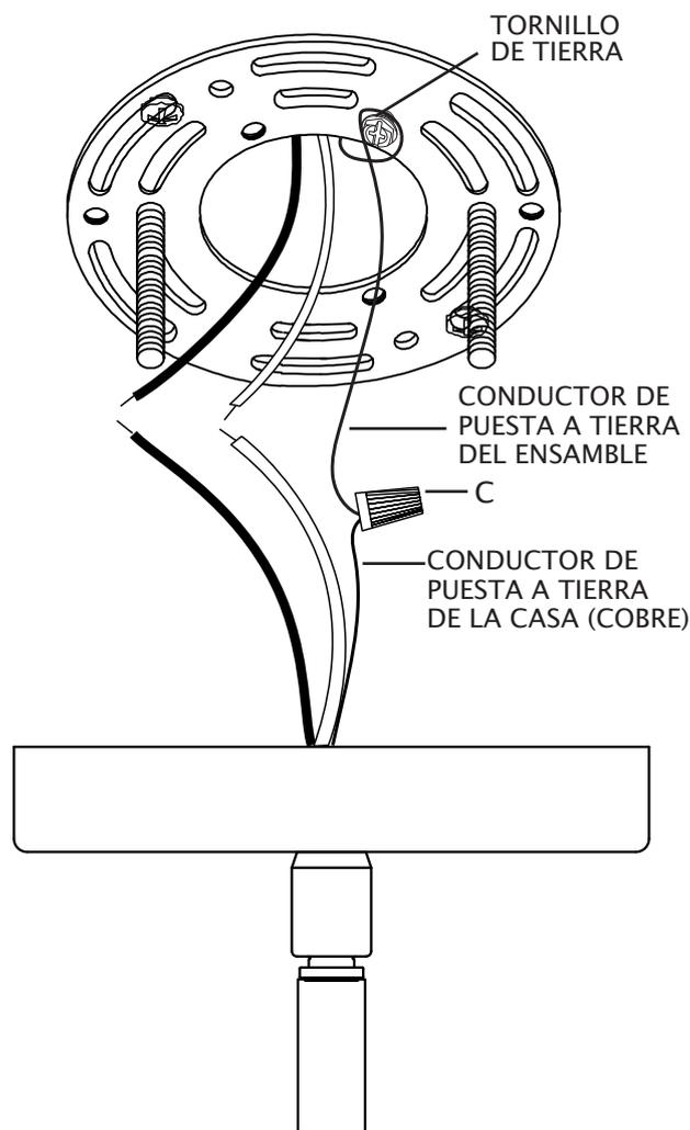
Conecte el conductor de cobre de puesta a tierra del suministro (casa) a:
