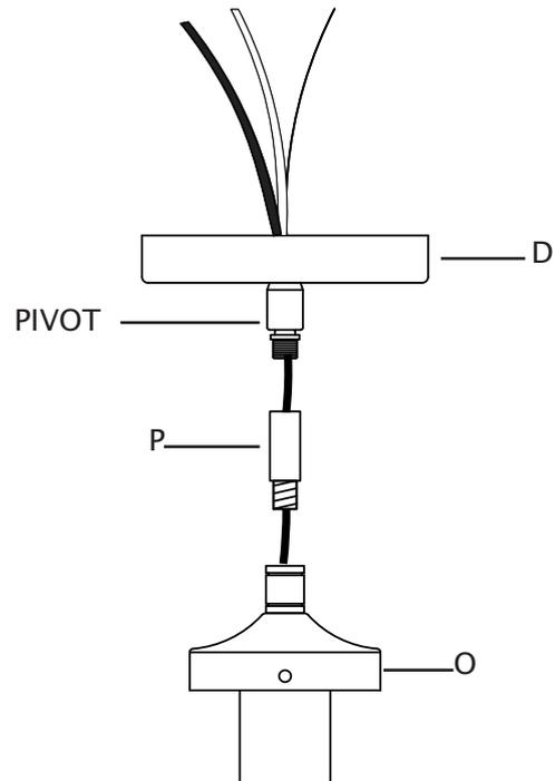
13. Dénudez l'extrémité des fils du luminaire sur 19,05 mm.
