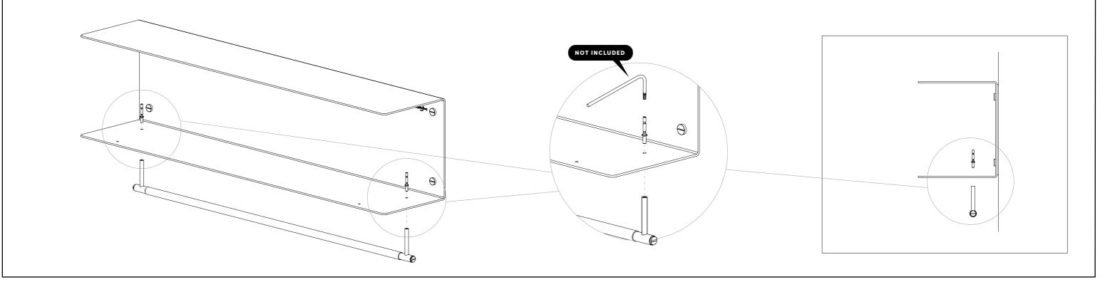
SCREW IN THE FOUR GRUB SCREWS TO THE HOLES ON THE BACK OF THE GUARD RAIL, ENSURING THEY ARE TIGHT.
