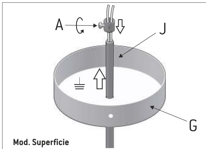
**7S- Modelo Superficie.** Pasar los cables hacia el interior de la sujeción (K). Figura 7S.
