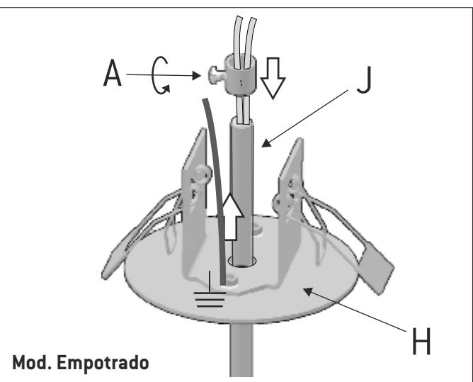
**10R- Modelo Empotrado.** Colocar el transformador, los conectores y la caja de conexiones en el interior del techo. Presionar las pinzas para introducirlas en el interior del agujero. Soltar las pinzas y la lámpara quedará fijada. Figura 10R.
