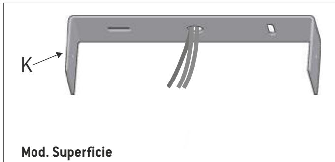
**8S- Realizar las conexiones eléctricas respetando las polaridades. Atornillar la sujeción (K) al techo. Figura 8S.**
