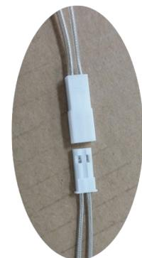
3- Raccorder les connecteurs en respectant l'orientation
