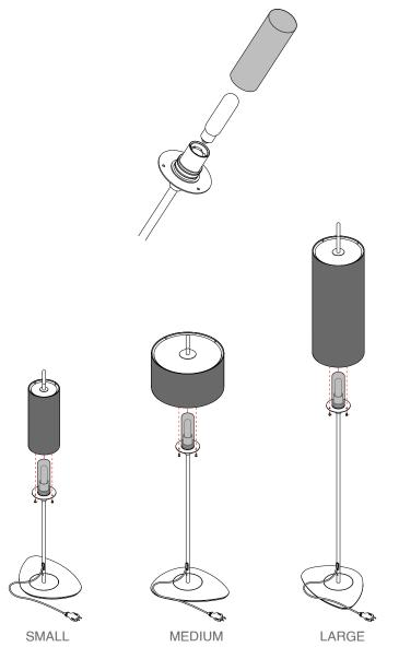
Fissare il paralume alla struttura tramite le tre viti fornite.
