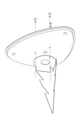
1 Fissare il picchetto alla base tramite le viti fornite assieme alla lampada.
