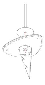
2 Fissare nuovamente il supporto alla base tramite la vite rimossa in precedenza.
