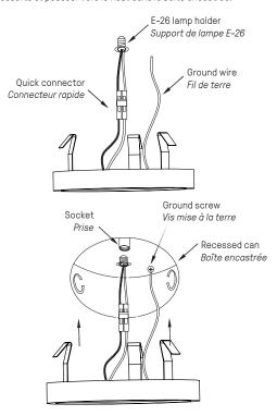
Complete the installation by pushing the fixture into the mounting plate. Terminez l'installation en poussant l'appareil dans la plaque de montage.
